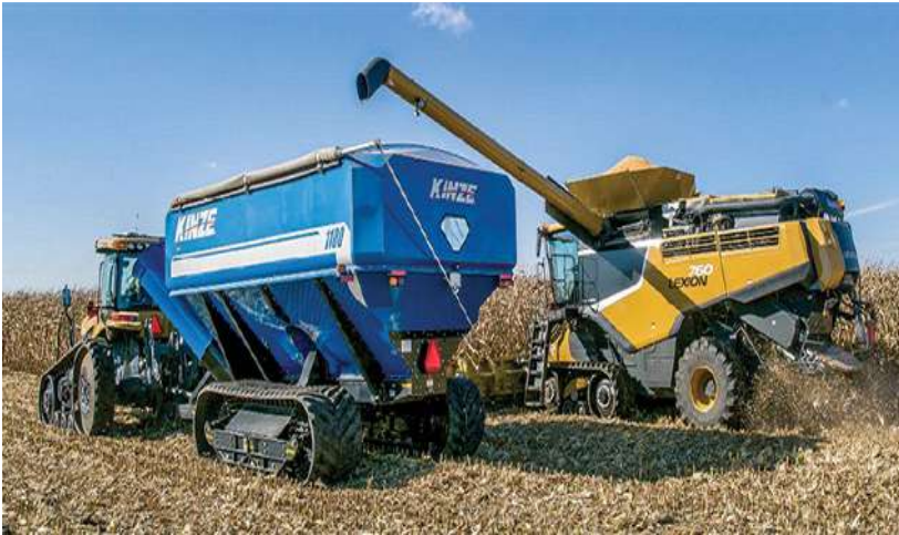
Figura 17. Combină agricolă, tractor și remorcă dotate cu șenile pentru limitarea compactării solului, utilizate în cadrul fermelor ce au adoptat sistemul de Agricultură Conservativă 23
