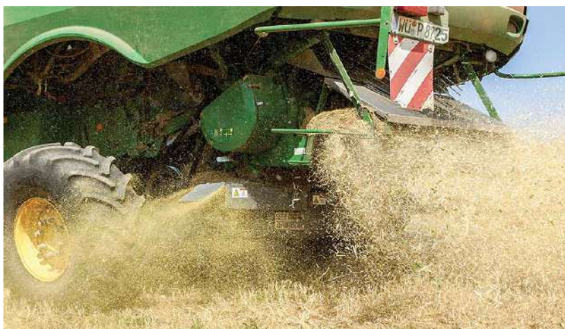
Figura 16. Tocarea resturilor vegetale și împrăștierea uniformă pe sol de către combina agricolă 22
