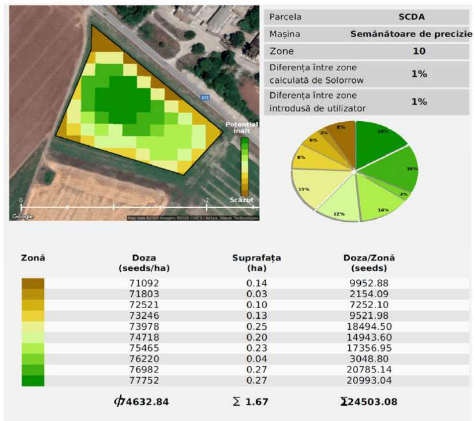
Fig. 7. Scanare satelitară Solorrow pentru stabilirea normelor de semănat la culturile succesive - SCDA Brăila - ADER 3.3.2. - Faza 2 / 2020
